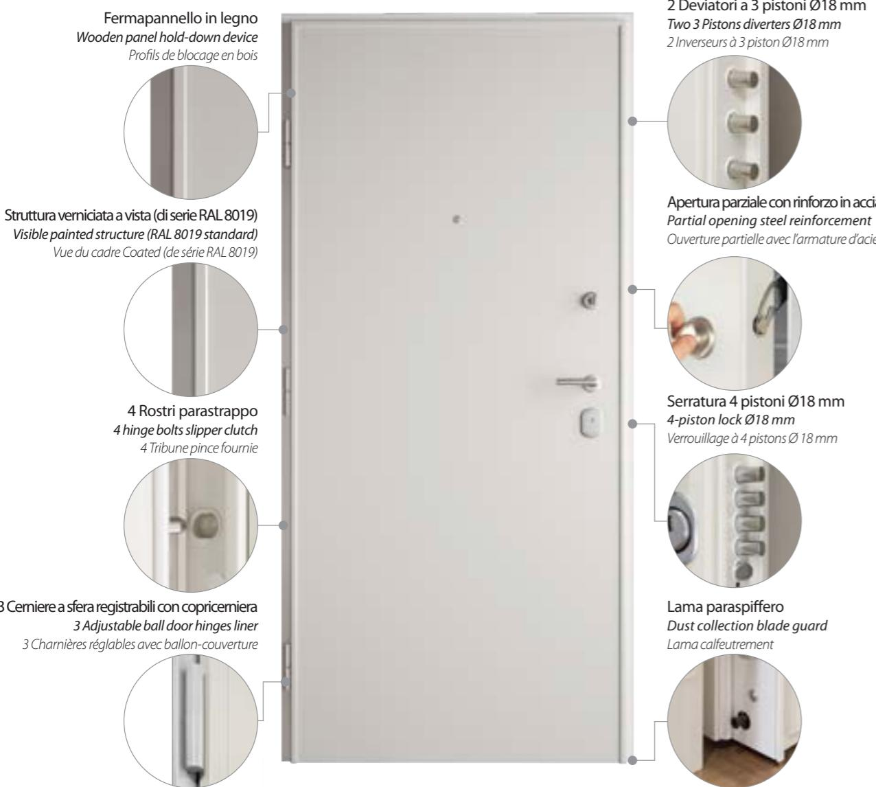
La porta blindata ELIDE in classe anti-effrazione C4 può essere realizzata solo nella versione a un'anta: dispone di struttura verniciata (di serie RAL 8019) con cerniere a vista e ferma-pannello interno in legno coordinato con la finitura del pannello. Le parti vetrate, qualora presenti, possono avere larghezza massima di 24 cm.
